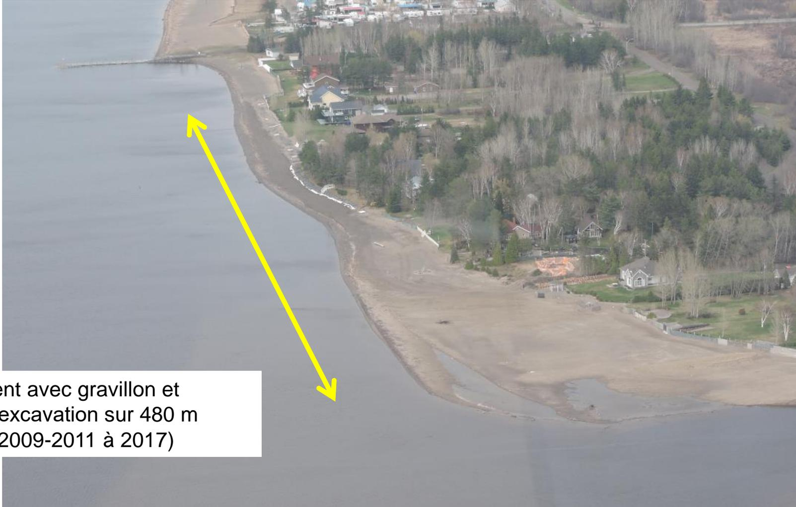
Rechargement avec gravillon et matériaux d'excavation sur 480 m (1993-1997-2009-2011 à 2017)
