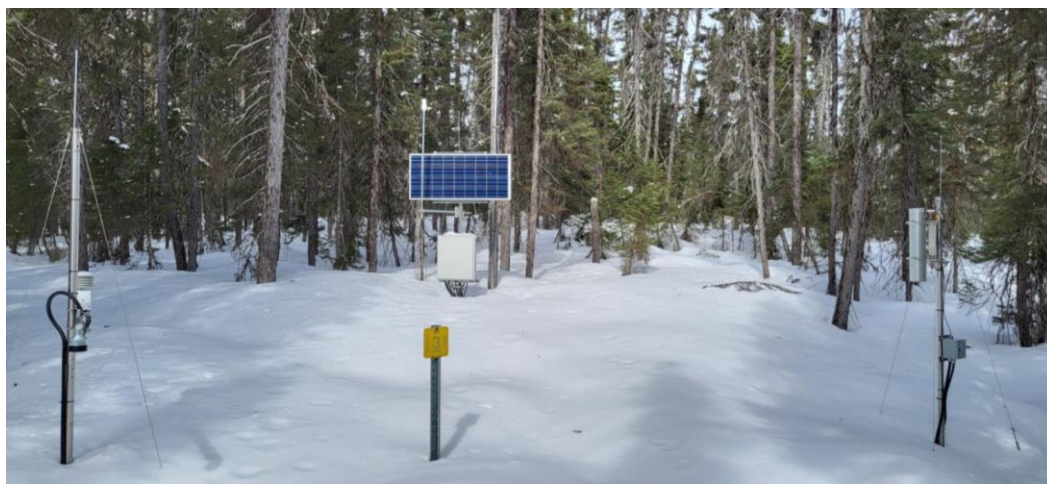
Mesure en continu de l'évolution de la neige au sol
