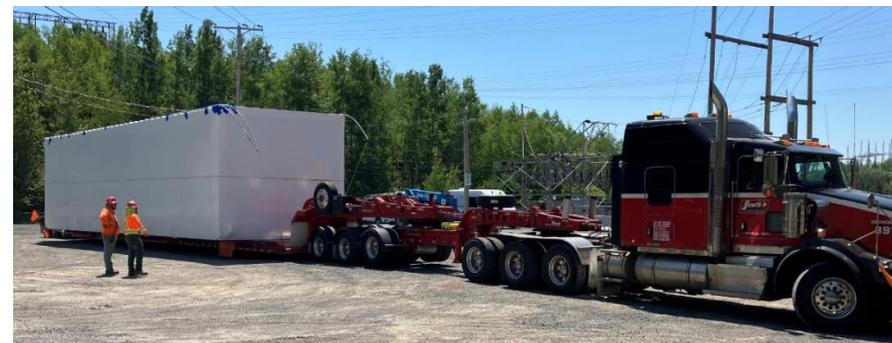
L'arrivée sur site du E-House, la station électrique du poste, par un transporteur spécialisé
