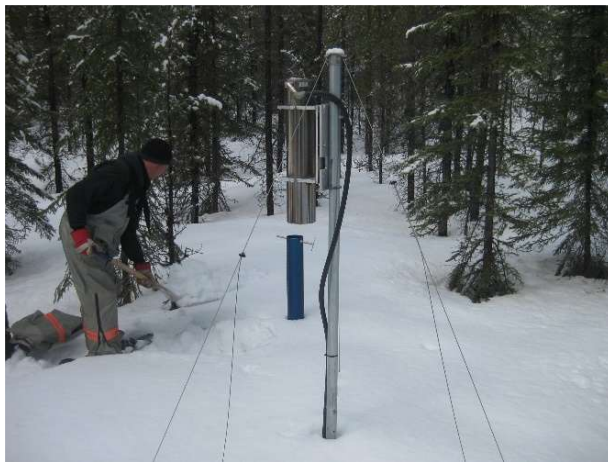
Réseau de GMON Mesure en continu de l'évolution de la neige au sol.
